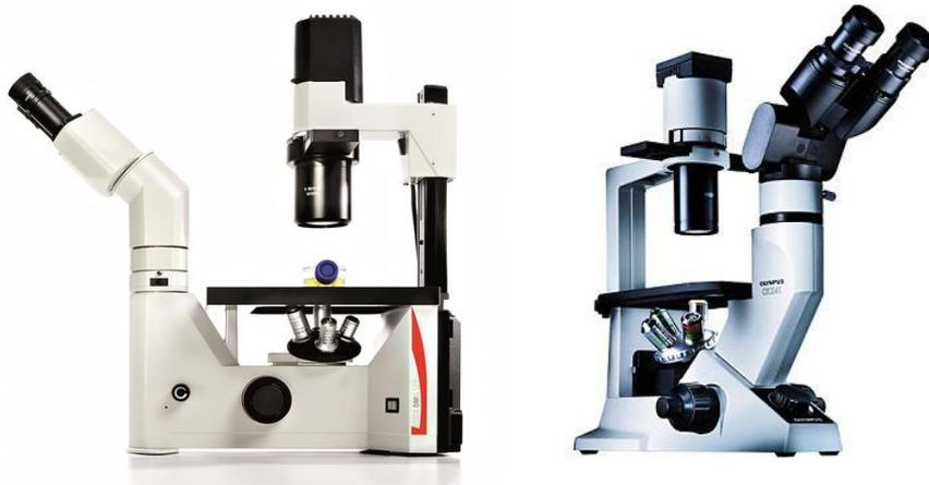
La segunda característica que condiciona el instrumento óptico es su ausencia de color, es decir se trata de muestras vivas y con poco contraste. El microscopio se equipa con el dispositivo de contraste de fases (diafragmas anulares a nivel del condensador y placa de fases entre las lentes del objetivo). De esta forma el contraste de la imagen aumenta y la calidad obtenida es muy superior.
